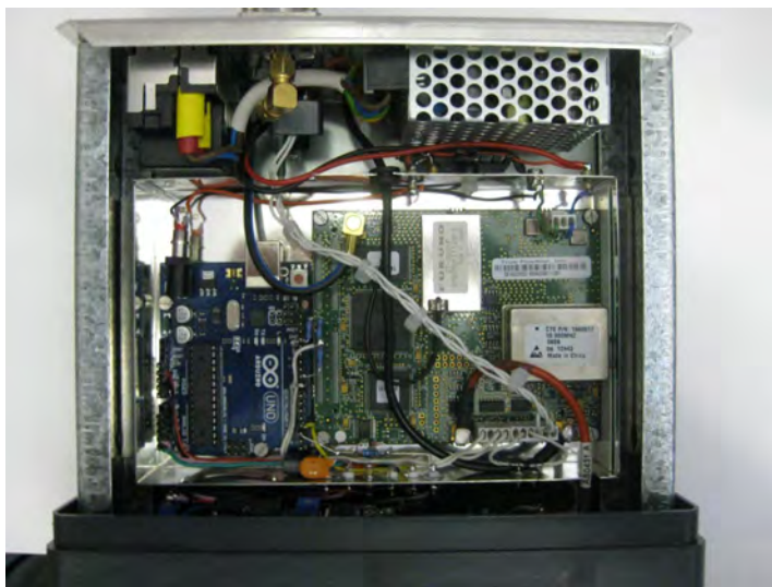
Foto 9 Binnenwerk Trimble-alias GPSDO met Arduino-Uno
