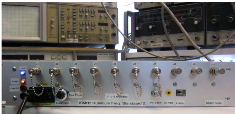
Foto 6 Rubidium Frequentie Standaard LPRO-101 met verdeelversterker.
