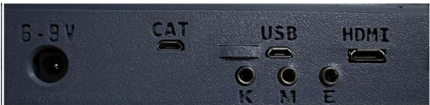
De connectoren aan de achterzijde. K, M en E staan voor Key, Mic en Earphones
