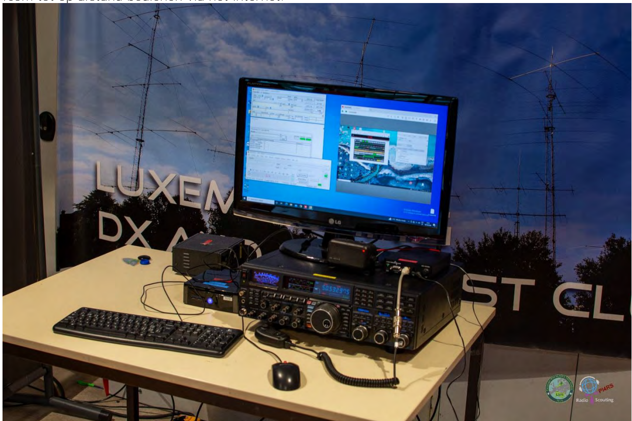
Voorbeeld Remote opstelling met Yaesu DX5000 met remote rig naar contest station LX7i
