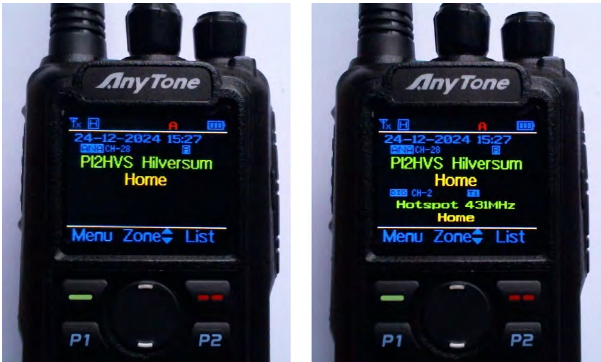
[Foto: AT878 hoofdscherm met en zonder sub mode.png met als beschrijving "Anytone 878 met daarop zichtbaar het hoofdscherm met sub mode uit- en ingeschakeld ."]
