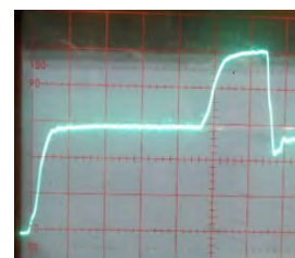
Een kabel zonder afsluiting
