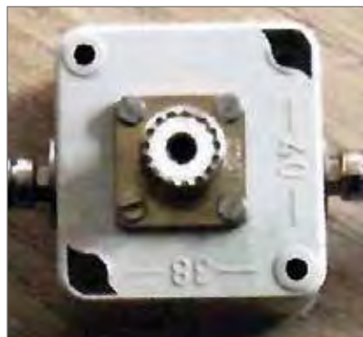
Een stevige ABS-behuizing voor de dipolen en de SO239-connector.
