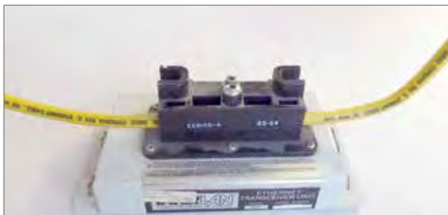
Figuur 2 | Gele 'thicknet'-kabel, met een 'vampire-tap' aangesloten op een ethernet-transceiver.
