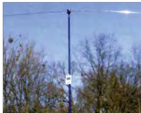
Dipoolantenne met geheel uitgeschoven telescoopstaven bij gebruik in de 6m-band.
