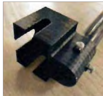
Masthouder voor de dipool uit de 3D-printer.
