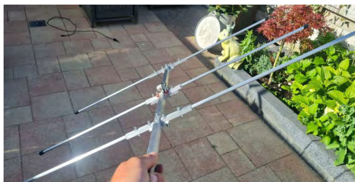
De RDF 10 seconden uitklap Yagi klaar voor gebruik
