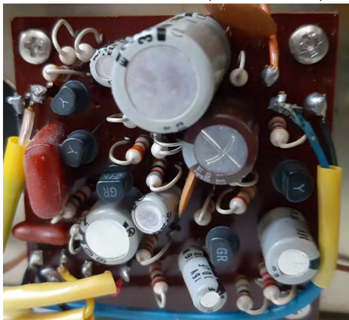
De vervangen condensator op het Tone Generator board: de bruine rechts onder de grote 330 \mu F condensator
