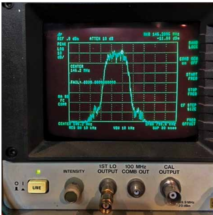
Spectrum van de eindtrap op 'vol gas'
