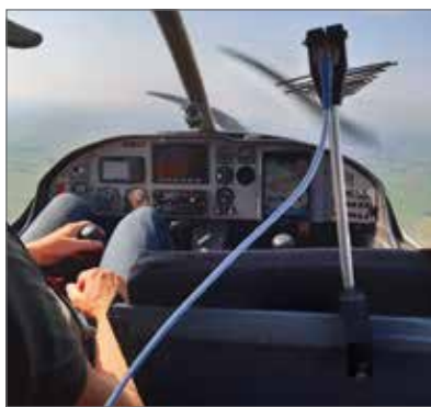
De logper-antenne (LPD) binnenboord
