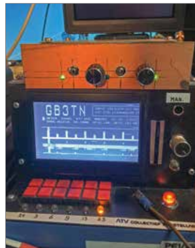
Het 23cm-testbeeld van de omzetter op 1316 MHz
