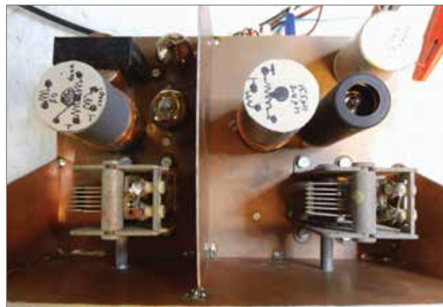
Een blik boven op de ontvanger toont duidelijk de twee verwisselbare spoelen en variabele condensatoren. De rechter helft is de ingangsversterker.
