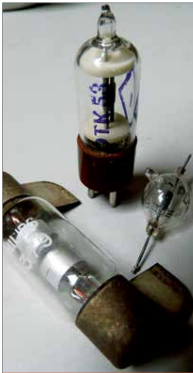
Enkele edelgaspatronen – surge arrestors. De kleine exemplaren waren standaard ussr; het staande model is geschikt voor parallel voedingslijn.
