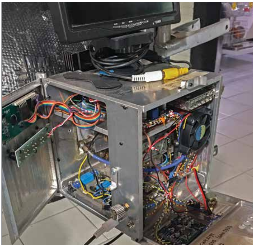
De compleet samengebouwde 47GHz-ontvanger met opengeklapte panelen
