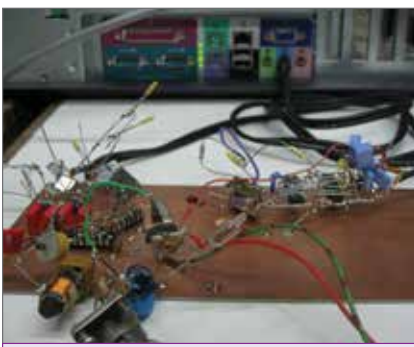
Fig. 1 | Kwadratuurmixers voor 80 en 40 meter, anno 2008
