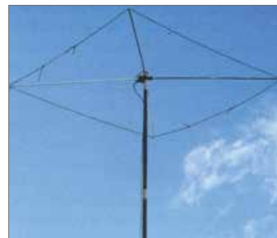
De complete antenne. De aluminium buizen zijn zichtbaar.
