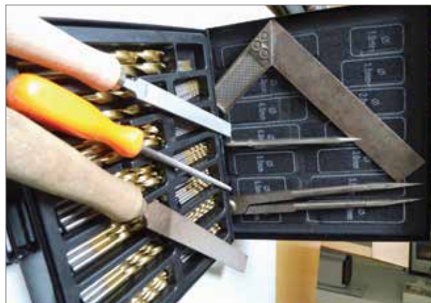
Foto 1 | Een setje HSS boren, een kleine stalen winkelhaak, een kraspen, een stalen passer om gaten af te tekenen en vijlen voor het ontbramen.
