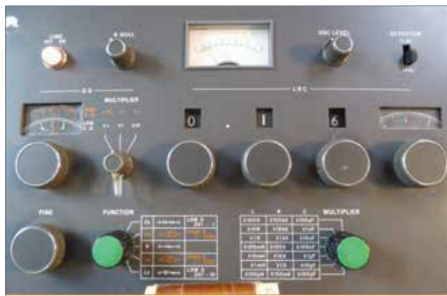
Foto 6 | Het proefspoeltje gemeten met een ouderwetse HP (kostbare) meetbrug. Mijn zelfbouw componententester (Van Dijken) geeft dezelfde waarde.
