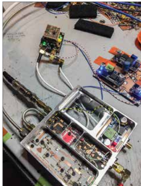
De samengebouwde transverter met de twee coaxkabeltjes voor de LO-signalen naar ontvanger en zender. De ADF 4351 met opsteekprintje ligt nog buiten.
