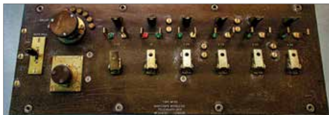
Afb. 4B | Voorkant van het ontvangerchassis
