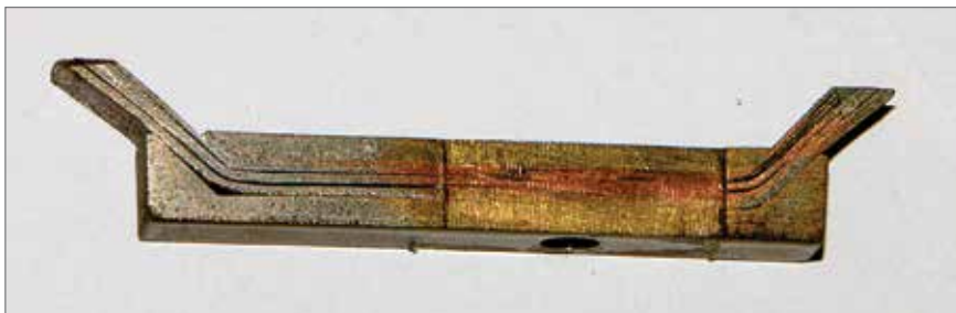
Afb. 6A | Schakelement, gezien vanaf bedienkant
