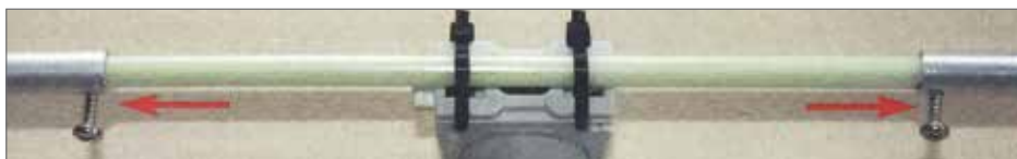
Verbinding van de open einden en het klemmen van de antenne op pvc-buis. De pijlen geven de afregelschroeven aan.
