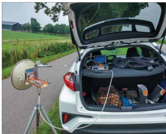
De mobiele opstelling van Lex op de ringdijk. Hier de 76 GHz-ontvanger
