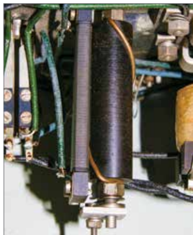
Afb. 5B | Potentiometer met beweegbaar contact in andere stand
