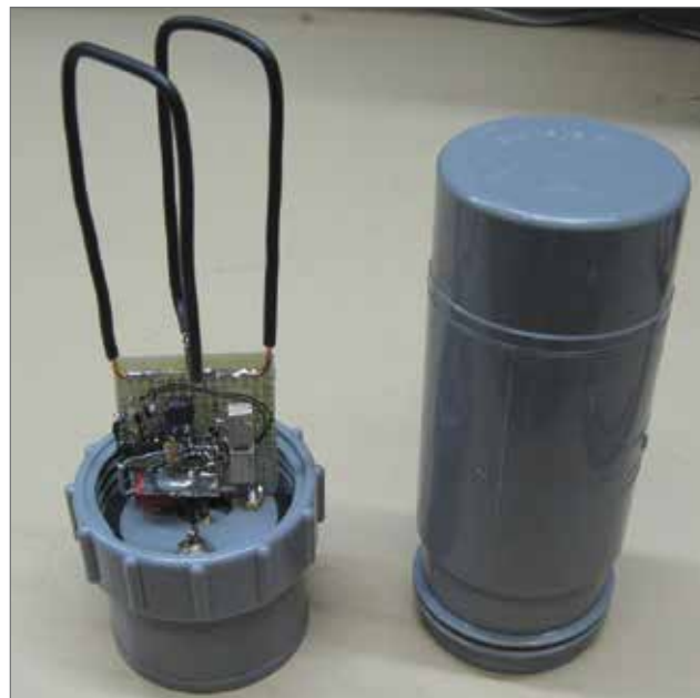
Figuur 4 | Antenne van de Twentse WebSDR
