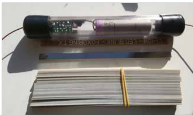
Zender met schakelaar, accu en laadprintje gemonteerd in plastic buis. Op de voorgrond een set printstroken om alles op te bouwen om in de buis te schuiven
