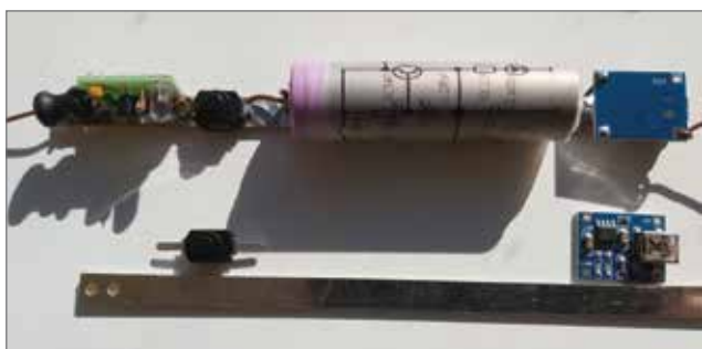
Zendertje, LiOn-accu, laadprintje en schakelaar met montage print ( onder)
