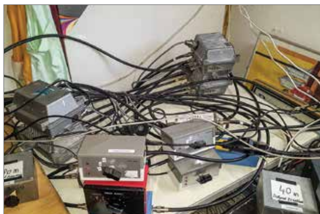
Afb. 2 | Het PACC-conteststation PA6X met een overzicht van het vele schakelwerk, filters, stackmatches en dergelijke voor de M2-klasse
