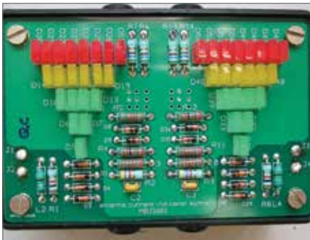
Fig. 10 | De afgebouwde antennestroomindicator voor symmetrische lijn
