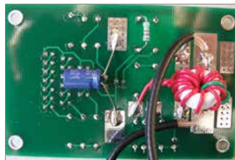
Fig. 4 | Onderzijde print voor coaxkabel
