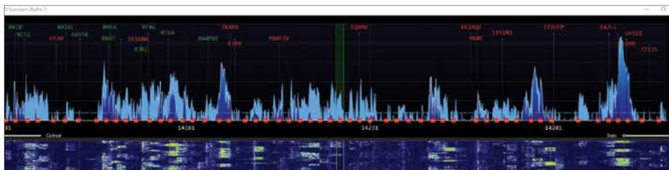
SpectrumSSB20 | Een superluxe spectrumdisplay waarin je snel de sterkste stations herkent en ziet waar de punten te halen zijn. Het biedt actuele informatie en meer details dan een bandmap, maar vraagt ook een luxere ontvanger
