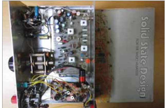
Idee 170 | Een must have: "Wes Haywards Solid State Design", een geweldig knutselboek. Erop een KG ontvangerijtje voor SSB/CW met ladderfilter gemaakt naar ideeën uit het boek
