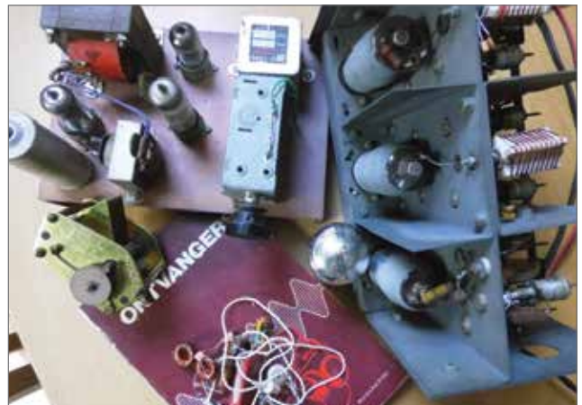
Idee 171 | Het boek van Sterrenburg met daarop een MG achterzet RX, een jaren 50 GEE- ontvanger omgebouwd tot convertor voor 20, 15 en 10 meter. Op het boek een proefje met een diodeontvanger uit de back to the future hype, een fraaie Engelse messing afstemcondensator met vertraging en een Philips A415 triode waarmee ik mijn eerste lampradio maakte
