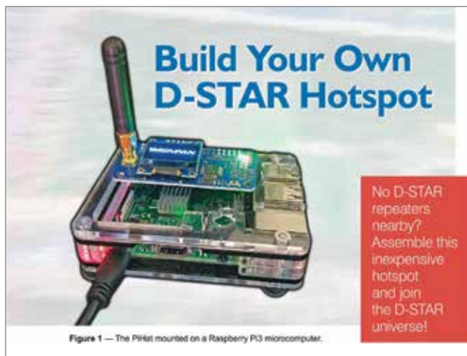
PiHat hotspot modem op een Raspberry Pi3
