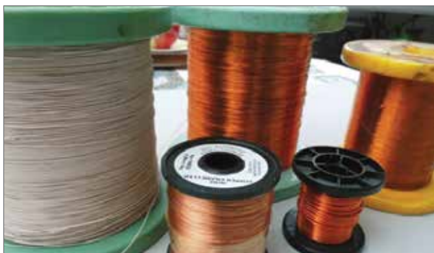
Een paar klosjes koperdraad. Op het kleine klosje met zeer dun draad (0,12 mm) zit meer dan 60 km. De klos links met grijs draad is litze, een bundel van 114 x 0,04 mm koperdraadjes omponnen met isolatie
