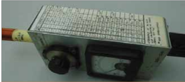
Mijn eigenbouw dipper met spoeltjes. De condensator wordt door een vertraging met schaal aangedreven. Op de zijkant een ijkijstje met per spoel de frequenties
