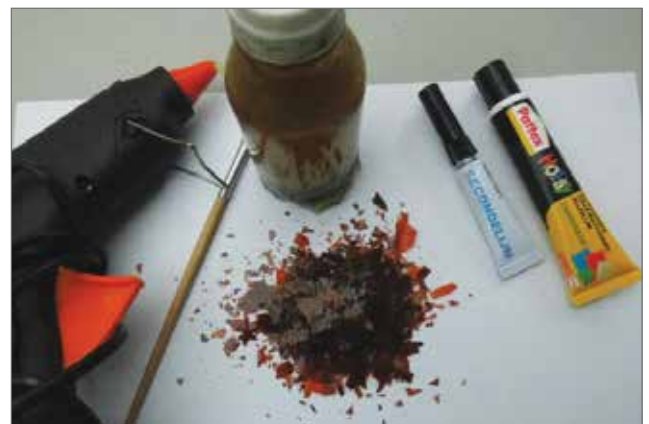
Verschillende lijmen om bijvoorbeeld spoelen stabiel te maken. De bruine schilfers zijn schellak. Die wordt opgelost in spiritus. In kunstwinkels nog te koop en wordt nog gebruikt als vernis en voor politoer. Niet afgebeeld: de hedendaagse tweecomponentenlijmen die prima geschikt zijn voor het lijmen van voetjes in spoelvormen
