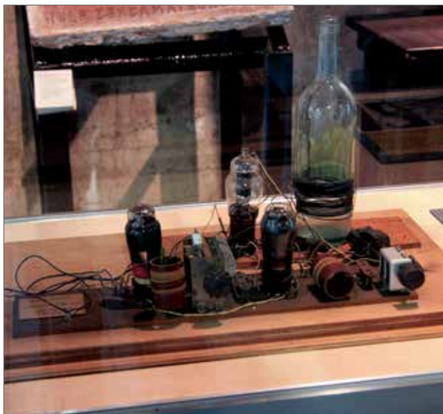
Replica van de flessenzender gemaakt door Cor van Doeselaar PA0AM
