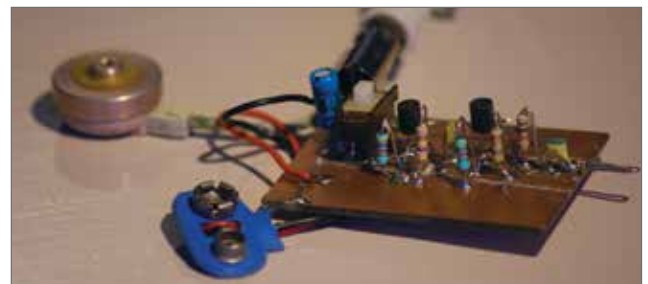
De signaal-gever/-volger gebouwd op een stukje printplaat waarin enkele groeven gekrast zijn met een hobbymes. Makkelijk en snel te bouwen, zeker als je het nodig hebt
