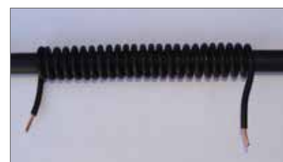
Afb. 5 | Spoel op ferrietstaaf
