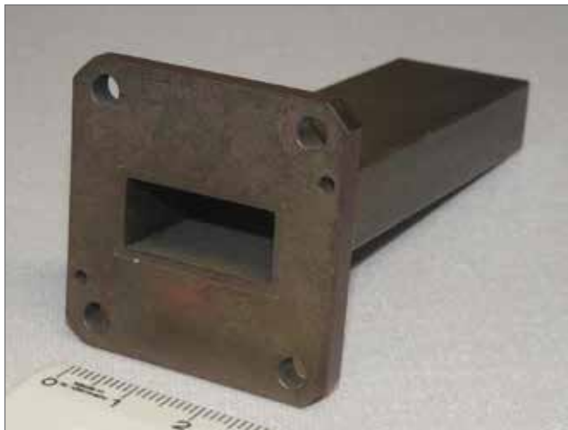
Figuur 1 | Een stuk WR90-golfpijp, geschikt voor 10 GHz
