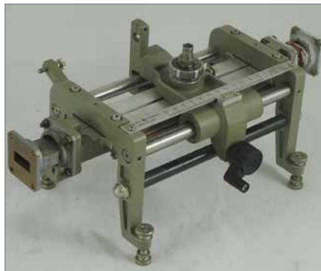
Figuur 6 | Slotted line voor 10 GHz
