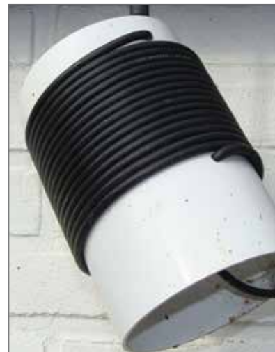
Afb. 1 / Spoel als mantelstroomfilter
