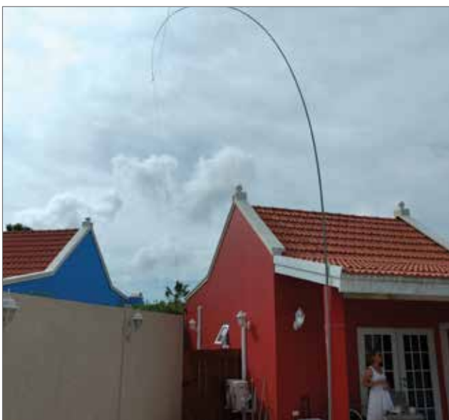
De antenneopstelling met de endfed vastgezet aan de kolom
