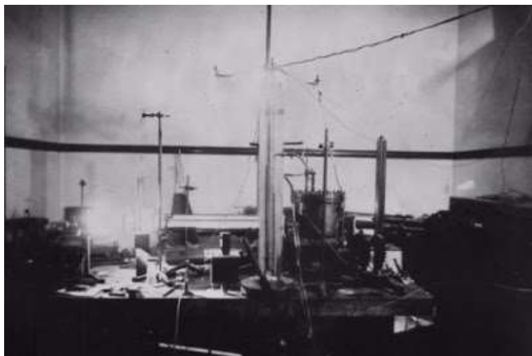
De originele opstelling van Millikan, waarmee de lading van het elektron werd gemeten. (Wikimedia Commons)
